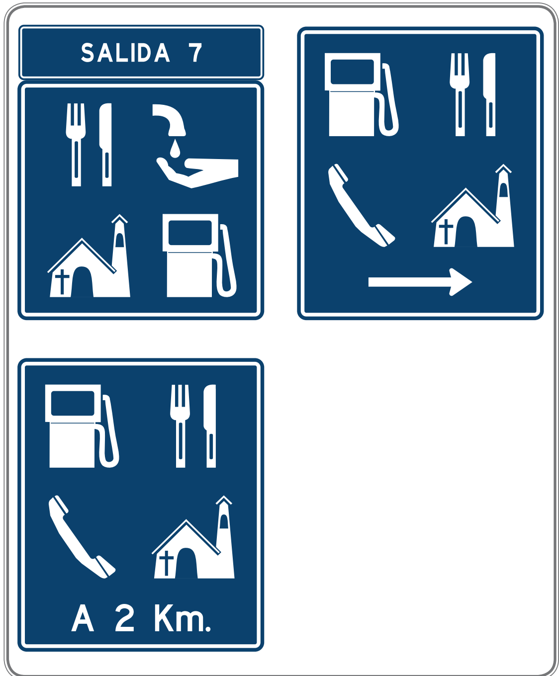
Figura 2.5-3 Panel de Señales de Sevicios Generales
