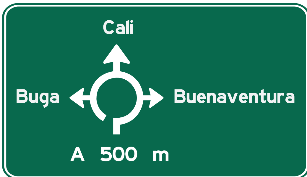
Figura 2.4-5 SI-05B Flechas de Destino en Señal de Glorieta
