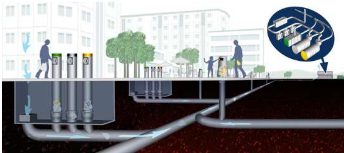
Imagen 6. Sistema de contenedores ENVAC en Suecia. Tomada de www.envacgroup.com . 2019.
