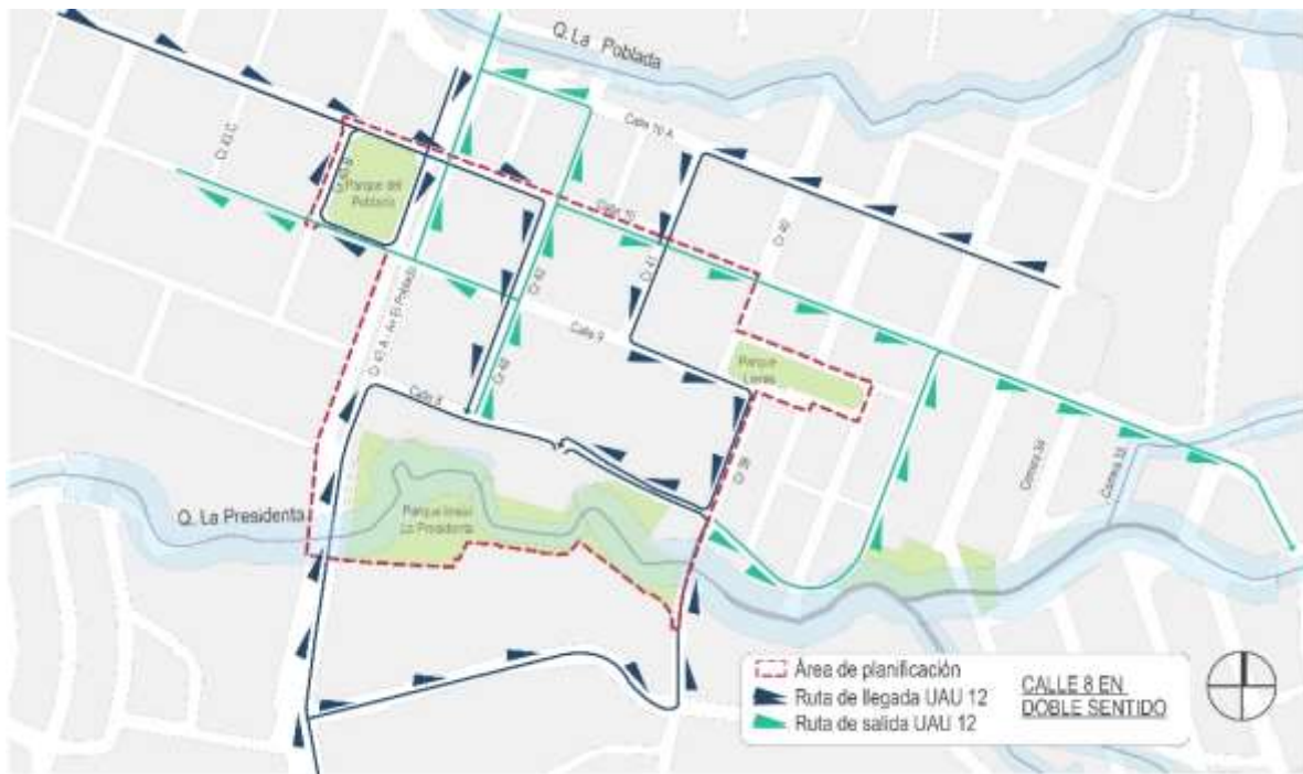
Ilustración 52. Esquema de rutas de llegada y salida con la calle 8 en doble sentido de circulación. Vías y Tránsito. 2019.
