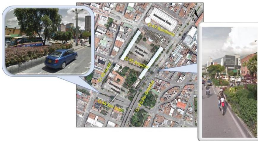
*Figura 40. Separador vial mixto (zona verde – infraestructura rígida).*
