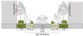
Carrera 53 A Entre calle 88 y 88 A
