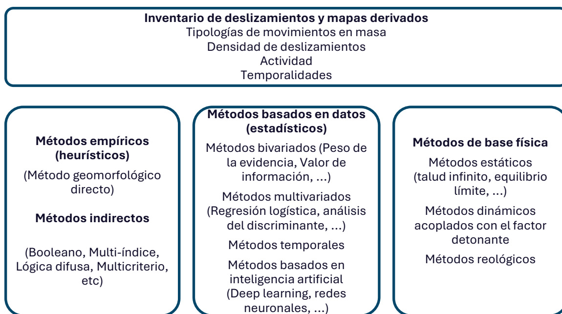
Ilustración 1. Clasificación de los métodos para la evaluación de la amenaza por movimientos en masa
