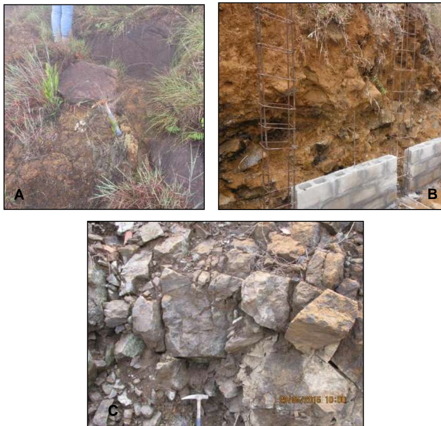
Figura 20. Horizonte IIA de meteorización A) Bloques en superficie por erosión superficial y B) y C) Bloques de dunitas fuertemente diaclasados
