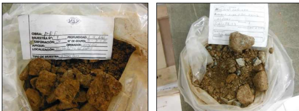
Figura 10. Llenos antrópicos en las Perforaciones P-EF-PR-31 y P-EF-PR-27
