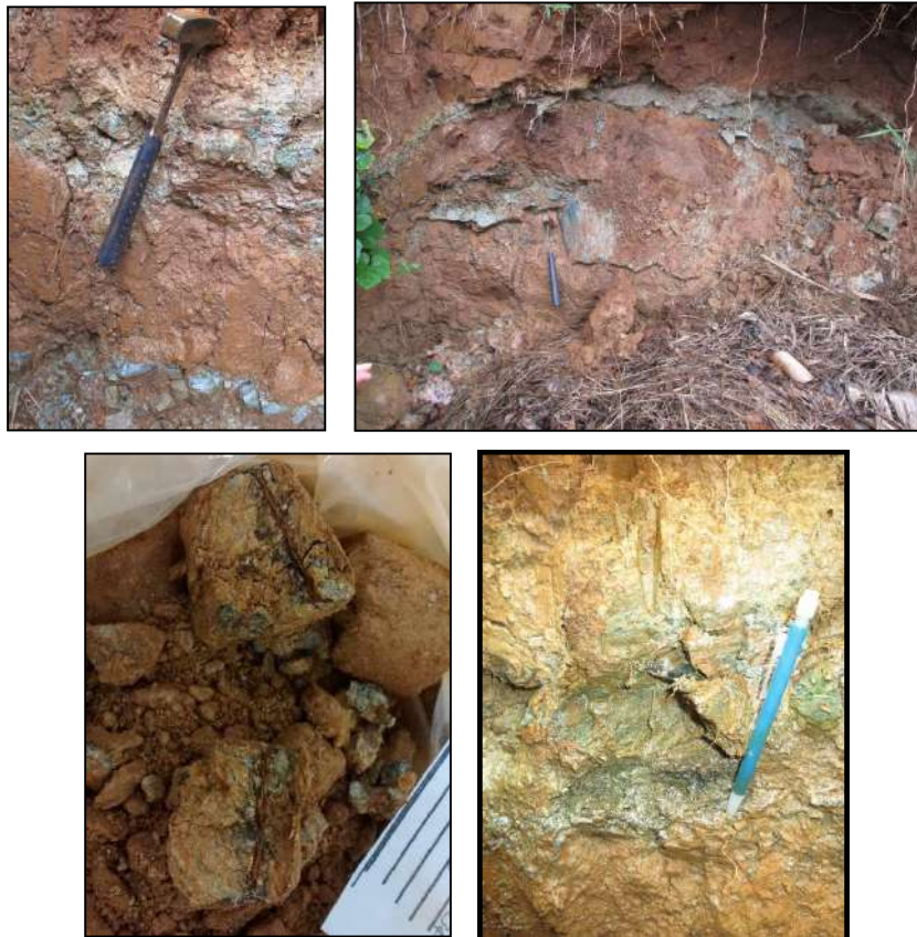
Figura 21. Horizonte IC de Dunitas con estructura esquistosa
