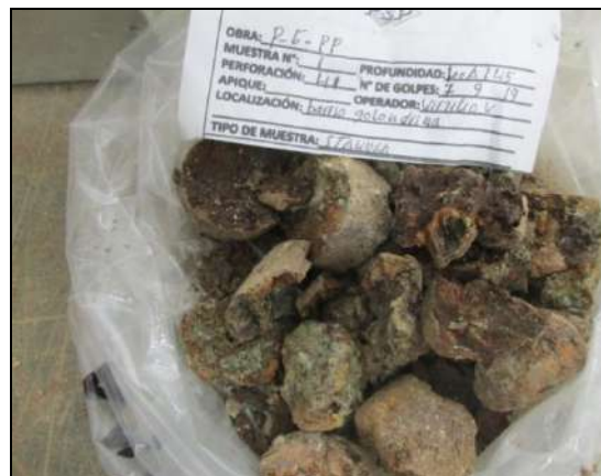
Figura 19. Depósito de flujos de lodos y/o encontrado en la Perforación P-G-PP-41
