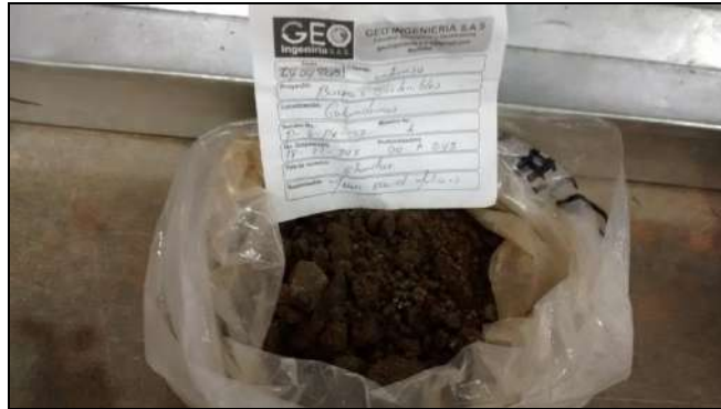
Figura 13. Lleno antrópico en la Perforación P-G-PR-33
