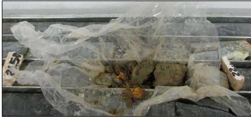
**Figura 19. Arcilla de falla en la Perforación P-LC-PR-35**
