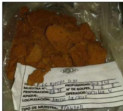
**Figura 11. Ceniza volcánica encontrada en la Perforación P-LC-PR-36**
