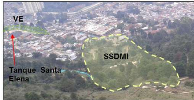
Figura 26. Unidad de Superficies Suaves sobre Depósitos Moderadamente Incisados SSDMI y Vertiente Escarpada VE
