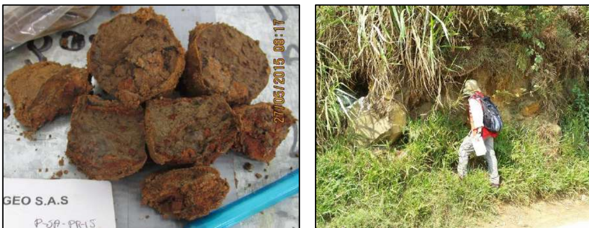
Figura 15. Depósito de flujo de lodos y/o escombros en Perforación P-SA-PR-15 (izquierda) y Estación de Campo KGL05-U-SA (derecha)
