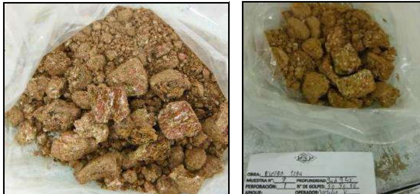
Figura 16. Horizonte IC-Gruss del cuerpo granítico en la perforación P-VT-PP-01
