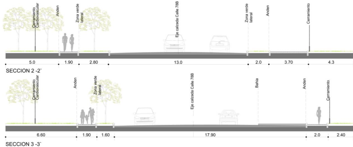
Imagen 20. Secciones de Vía Actual.
