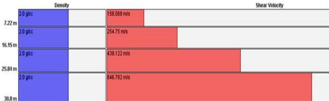
Figura 149. Perfil de velocidad de propagación de onda de corte (S) Línea L1.
