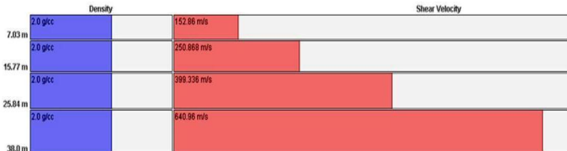
Figura 150. Perfil de velocidad de propagación de onda de corte (S) Línea L2.
