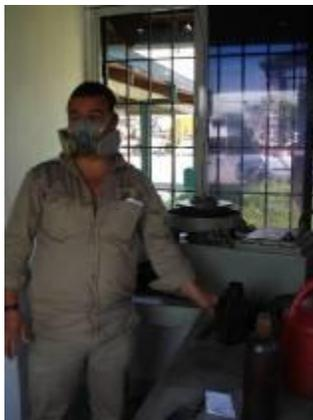
Foto 84 Centro de Acopio y Reciclaje de Pavimento. Interior de la caseta donde se realiza la extracción de asfalto por centrífuga con gasolina. Se observa el uso de algunos de los elementos de protección personal. Aunque el lugar cuenta con una unidad sanitaria, es evidente la carencia de duchas de seguridad ante cualquier tipo de emergencia.
