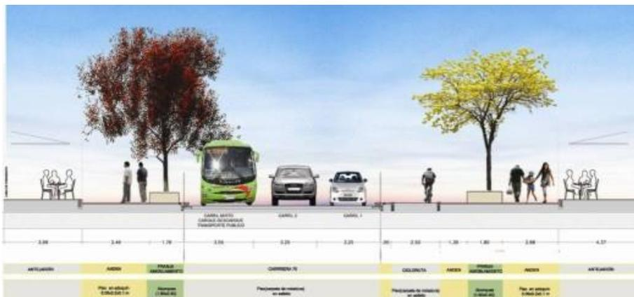
Figura 10. Propuesta Sección Vial Carrera 70 – Tramo III.
