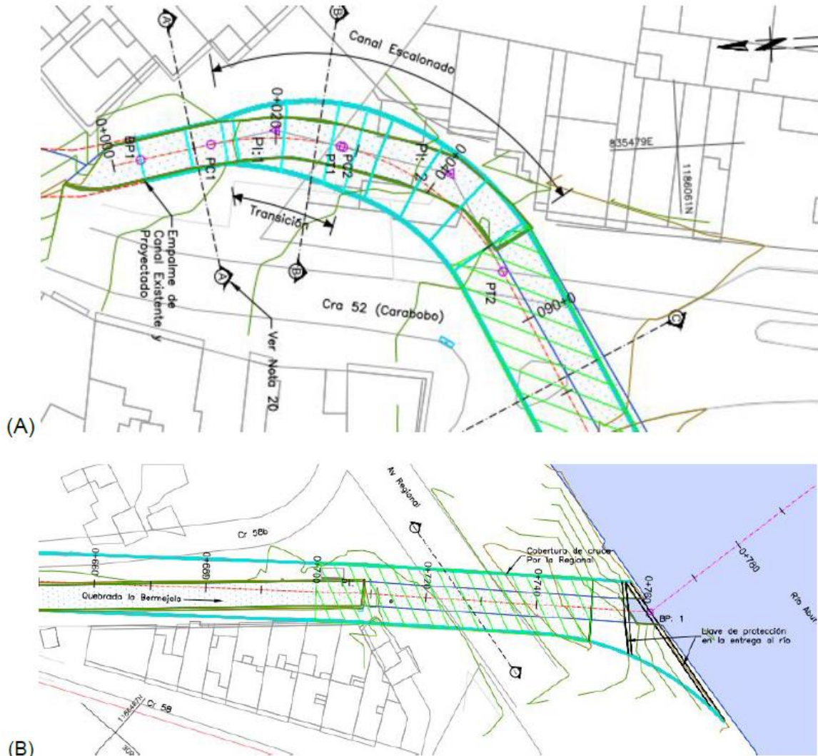
Figura 17. (A) Canal escalonado al inicio del canal en la quebrada La Bermejela. (B) Obra de entrega al río Aburrá para el canal de la quebrada La Bermejela.
