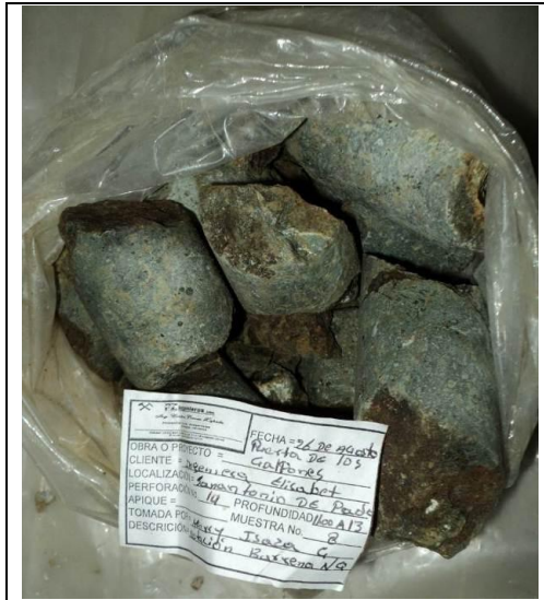
FOTO 94. Aspecto de la roca fracturada (muestra perteneciente al sondeo P-14).
