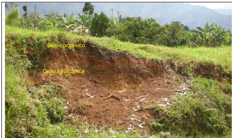
FOTO 98. Aspecto capa de ceniza volcánica en talud sobre vertiente izquierda de la quebrada La Limona
