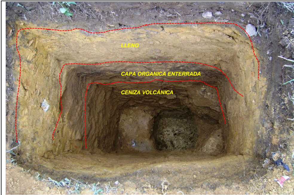
FOTO 99. Aspecto del material de lleno en contacto con la capa orgánica y ceniza volcánica registrado en el apique 1
