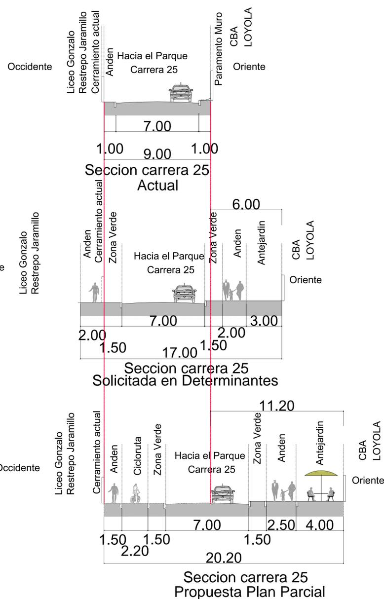
SECCIONES VIALES ESC: 1/150
